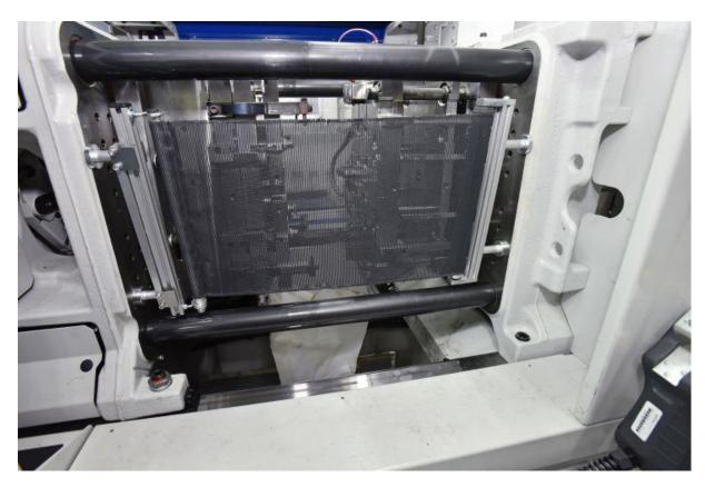
Ein schwimmend gelagertes Schutzrollo sorgt für, dass Gutteile sicher in den Auffangbehälter fallen. (Bild: IMS Gear)
